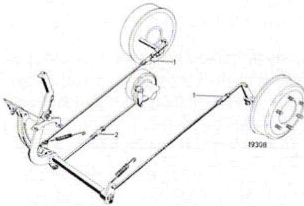
Zum Nachstellen der Hinterradbremse werden die Kontermuttern der Spannhülsen (1) an beiden Bremszugstangen (links und rechts) gelöst und die Hülse soweit im Uhrzeigersinn verdreht, bis der Totgang beider Bremsfußhebel – gemessen an der Fußauflage – ca. 30 mm beträgt. Anschließend die Muttern wieder gut festziehen.
