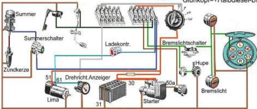
Es empfiehlt sich, eine einfache Prüflampe im Bulldog-Schuppen zu haben, obwohl die Anlage bereits 10 Jahre ohne Störungen funktioniert hat. Schwachpunkte sind die unter Dauerspannung stehenden Leitungen von 30 zur Lima 51, zum Starter 30 und zum Zündlichtschloß 30. Sie sind nicht abgesichert. Bei Massekontakt kann es zum Kabelbrand und Schlimmerem kommen. Abhilfe durch einen sg. Knochen oder Abklemmen des Minuspols an der Batterie wäre sinnvoll.
